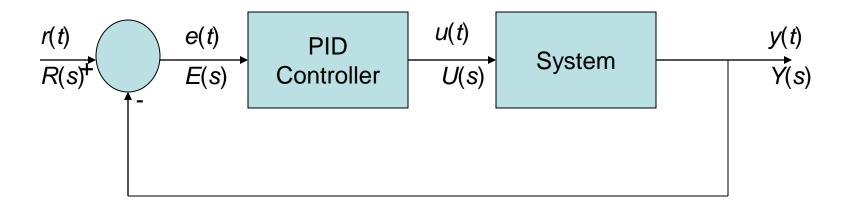
$$G(s) = \frac{Y(s)}{R(s)} = \frac{G_{sys}(s)G_{PID}(s)}{1 + G_{sys}(s)G_{PID}(s)}$$
